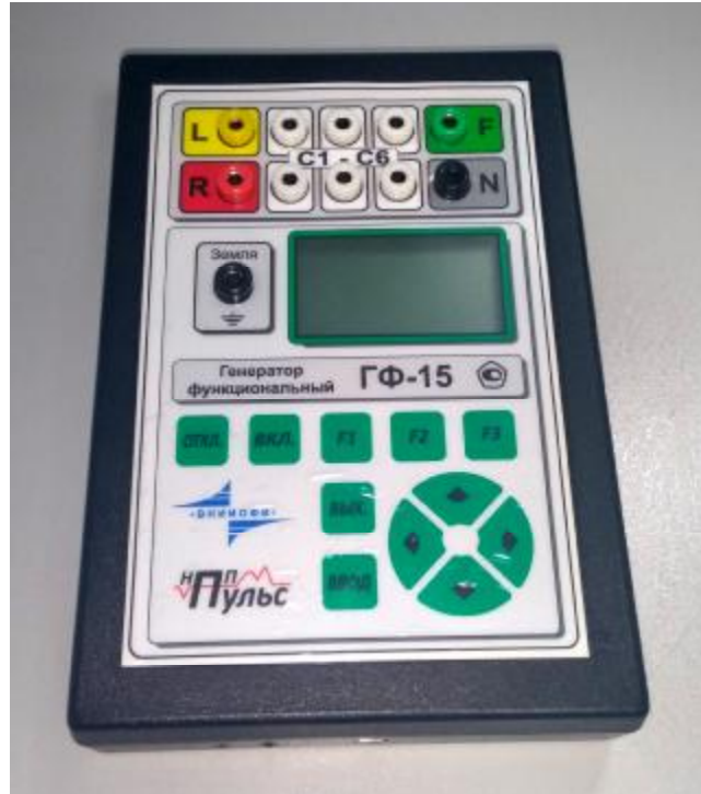
Р и с у н о к А.1 – Общий вид генератора ГФ-15
